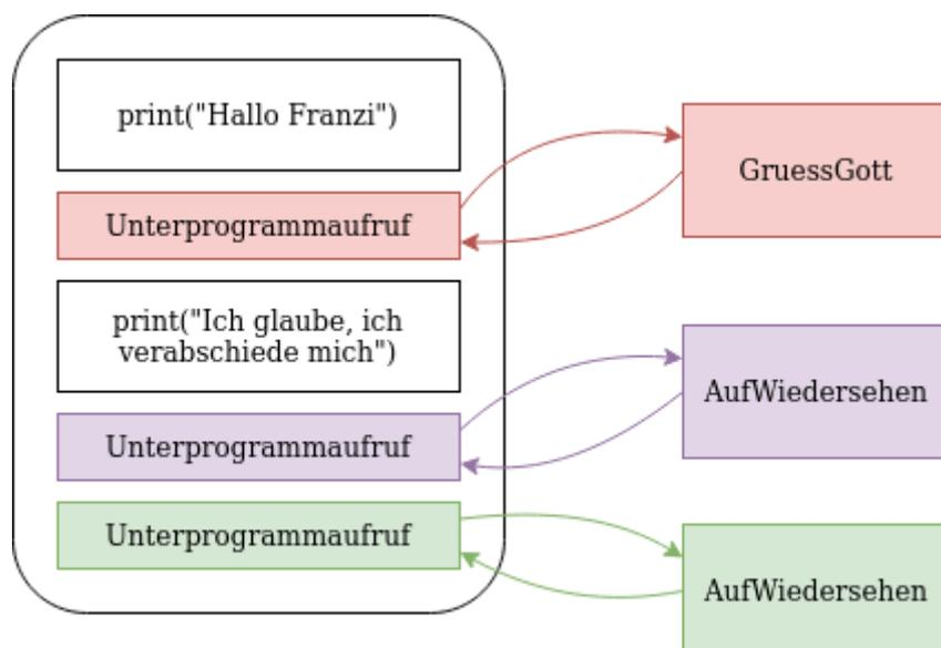
Dabei fällt auf, dass der Programmablauf nach jedem Aufruf eines Unterprogramms zu der Stelle zurückkehren muss, von der dieses aufgerufen wurde. Das wird dadurch realisiert, dass beim Aufruf einer Methode/Funktion auf dem Programmaufrufstack für jede Methode ein Speicherbereich reserviert wird, in dem alle relevanten Infos festgehalten werden, unter anderem auch die Rücksprungadresse, also die Stelle, von der aus die Methode gestartet wurde.
