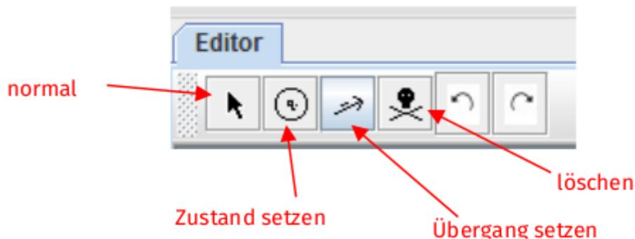
Wenn du mit der linken Maustaste den Kreis anklickst, bist du in dem Modus, in dem Zustände erzeugt werden können.
