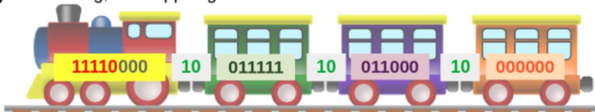
**(4) „UTF-8 Lok“, kennt die Zahl der Zugteile + 0 als Trenner + Padding + Ladung der Lok → Anhänger mit je 6 Bit**
