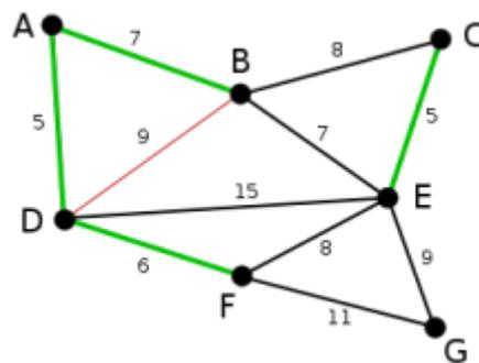
Jetzt könnten die Kanten AB und BE, jeweils mit Länge 7, ausgewählt werden. Es wird zufällig AB gewählt. Die Kante BD wird rot markiert, da sie mit den bis jetzt gewählten Kanten einen Kreis bilden würde und somit im weiteren Verlauf des Algorithmus nicht mehr berücksichtigt werden muss.
