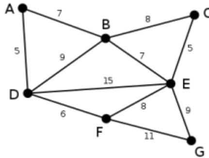
Dies ist der Graph, zu dem der Algorithmus von Kruskal einen minimalen Spannbaum berechnen wird. Die Zahlen bei den einzelnen Kanten geben das jeweilige Kantengewicht an. Zu Beginn ist noch keine Kante ausgewählt.
