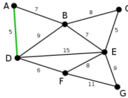
Die Kanten AD und CE sind die kürzesten (noch nicht ausgewählten) Kanten des Graphen. Beide können ausgewählt werden. Hier wird zufällig AD ausgewählt. (Dass diese keinen Kreis bildet, ist im ersten Schritt selbstverständlich.)
