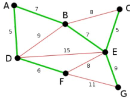
Als letzte wird die Kante EG mit Länge 9 ausgewählt, da alle kürzeren bzw. gleich langen Kanten entweder schon ausgewählt sind oder einen Kreis bilden würden. Die Kante FG wird rot markiert. Da nun alle nicht ausgewählten Kanten einen Kreis bilden würden (sie sind rot markiert) ist der Algorithmus am Ende angelangt und der grüne Graph ist ein minimaler Spannbaum des zugrundeliegenden Graphen.
