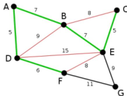
BE ist nun mit Länge 7 die kürzeste der noch nicht ausgewählten Kanten und da sie mit den bisher gewählten keinen Kreis bildet, wird sie ausgewählt. Analog zur Kante BD im letzten Schritt werden jetzt die Kanten BC, DE und FE rot markiert.
