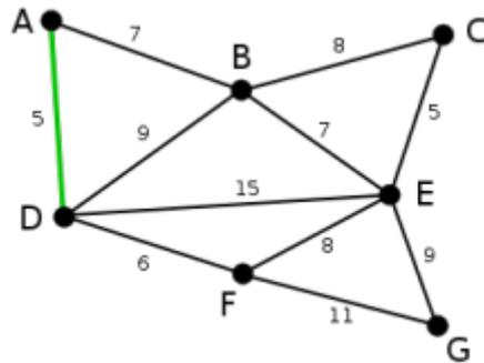
Die Kanten AD und CE sind die kürzesten (noch nicht ausgewählten) Kanten des Graphen. Beide können ausgewählt werden. Hier wird zufällig AD ausgewählt. (Dass diese keinen Kreis bildet, ist im ersten Schritt selbstverständlich.)
