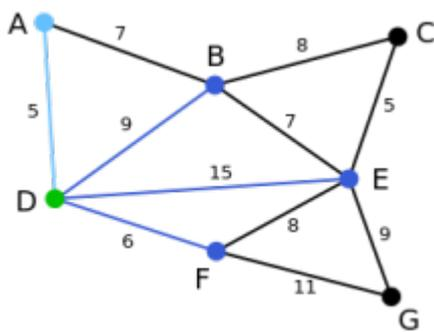
Als Startknoten für den Spannbaum T wird der Knoten D gewählt. (Es könnte auch jeder andere Knoten ausgewählt werden.) Mit dem Startknoten können die Knoten A,B,E und F jeweils unmittelbar durch die Kanten DA, DB, DE und DF verbunden werden. Unter diesen Kanten ist DA diejenige mit dem geringsten Gewicht und wird deshalb zusammen mit dem Knoten A zum Graphen T hinzugefügt.
