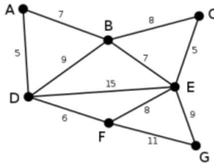
Dies ist der Graph, zu dem der Algorithmus von Prim einen minimalen Spannbaum berechnet. Die Zahlen bei den einzelnen Kanten geben das jeweilige Kantengewicht an.
