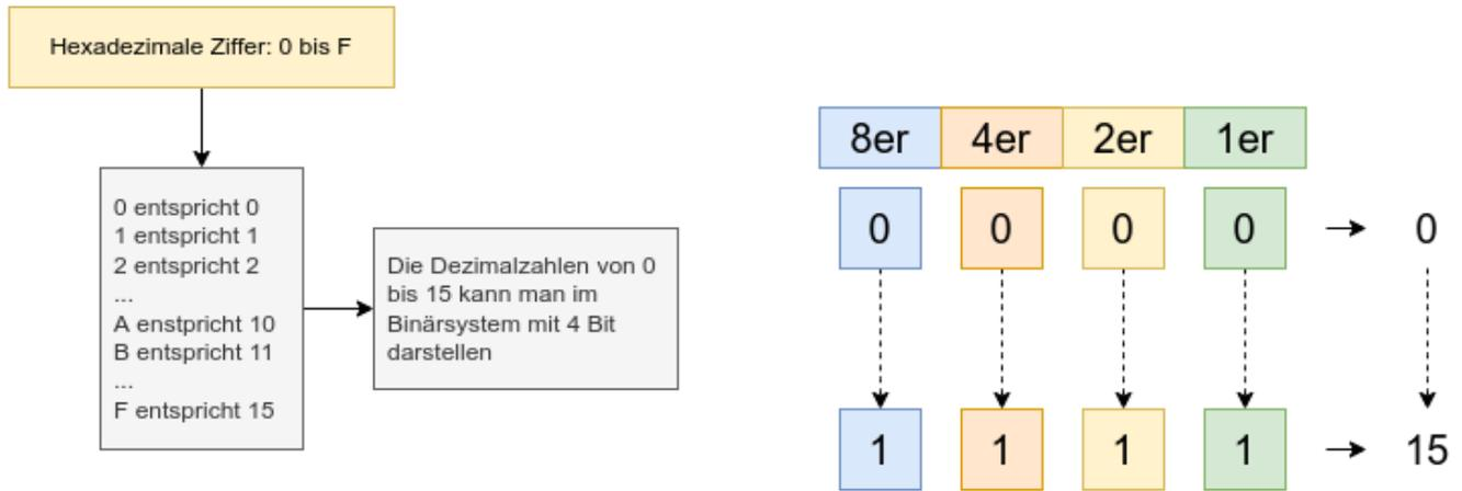
Also entspricht **eine** hexadezimale **Ziffer 4 Bit**, **zwei** hexadezimale **Ziffern** also **8 Bit** und damit einem Byte
