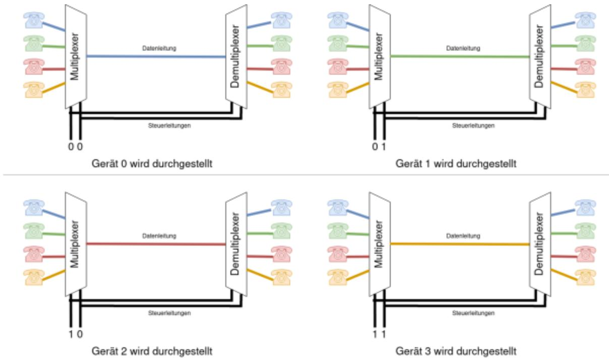
Die Signale auf den Steuerleitungen sorgen dann dafür, dass Multiplexer und Demultiplexer synchron arbeiten.
